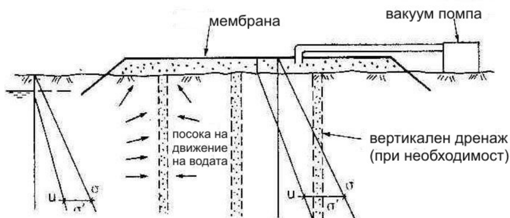
Фиг. 5.4. Създаване на свръхтовар чрез вакуумиране.
