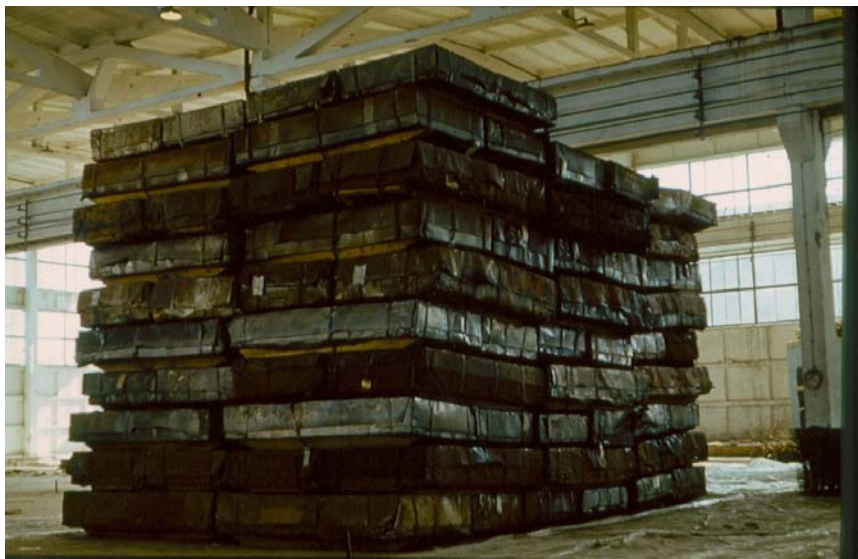
Фиг. 10.1. Изпитване на циментопочвена възглавница с щамп с площ 24 \text{ m}^2 . Възглавницата е с дебелина 1,5 \text{ m} , с E_o=95,0 \text{ MPa} , а на льоса под нея E_o=20,0 \text{ MPa}
