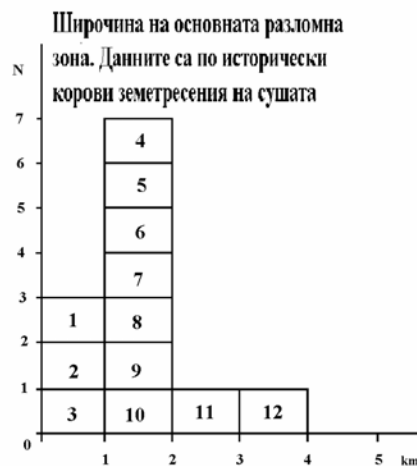
Фиг.8.1. Групиране на сеизмогенните разломи и честотно разпределение на широчината на основните разломни зони, появили се при исторически земетресения на сушата (Matsuda, 1990). 1 - Южно Изду през 1974 г.; 2 - Микава през 1945 г.; 3 - Северно Изду през 1930 г.; 4 - Ел Аснам през 1980 г.; 5 - Сан Фернандо през 1971 г.; 6 - Дикси Вели през 1954 г.; 7 - Фервю Пик през 1954 г.; 8 - Тотори през 1943 г.; 9 - Танго през 1927 г.; 10 - Руку-у през 1986 г.; 11 - Ноби през 1891 г.; 12 - Плисант Вели през 1915 г.
