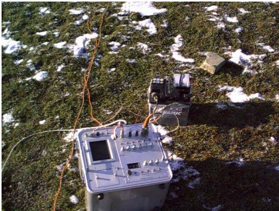
Фиг. 12.4. Сеизмичната апаратура ОУО – 6 канална, в работно състояние.
