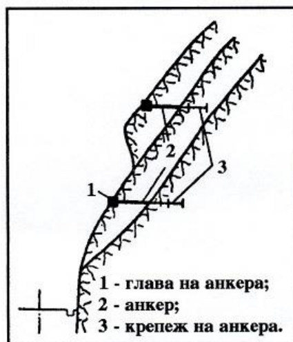
Фигура 23. Закрепване на скални блокове чрез анкери и стоманени болтове
