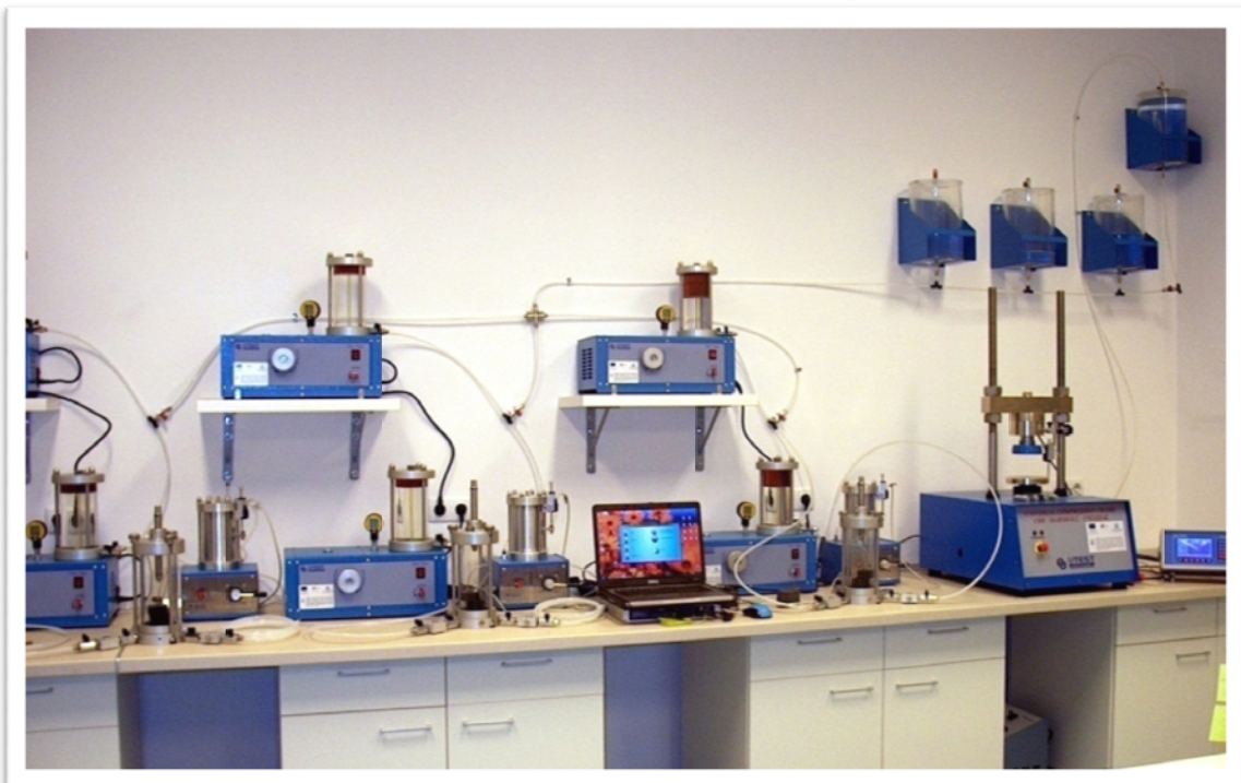
Фиг. 1. Съвременна лаборатория за физикомеханични изпитвания на естествени и заздрави строителни почви, оборудвана в резултат на успешно изпълнен проект по Оперативната програма „Развитие на конкурентоспособността на българската икономика” 2007-2013
