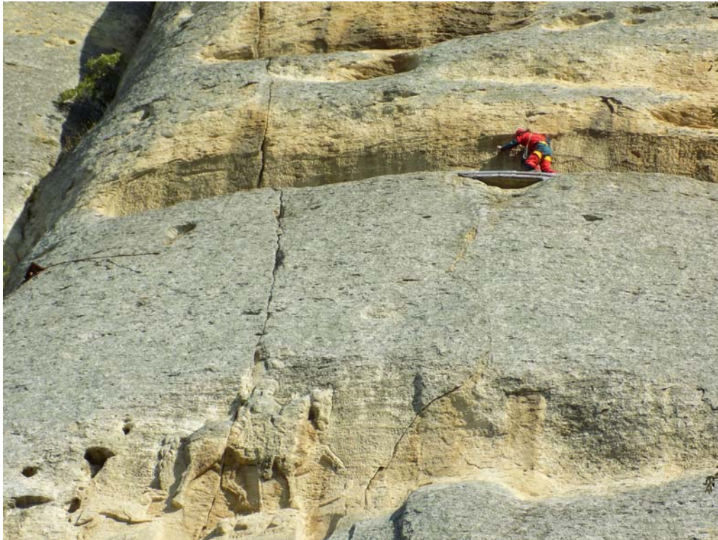
Инструментален мониторинг на опасни пукнатини, застрашаващи паметника на културата „Мадарски конник“ (на снимката доц. К. Костов)
